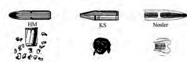
Fig. 17 Modalità di deformazione della palla
