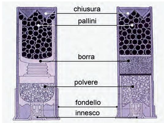
La polvere (da sparo) è la componente che permette, con la sua combustione, di sviluppare l'energia che fornisce la spinta al proiettile.
