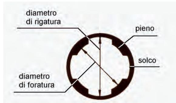
Fig. 3 - Sezione trasversale della canna rigata.
